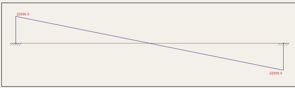
Esforço Cortante da Viga Metálica de 10 metros.
