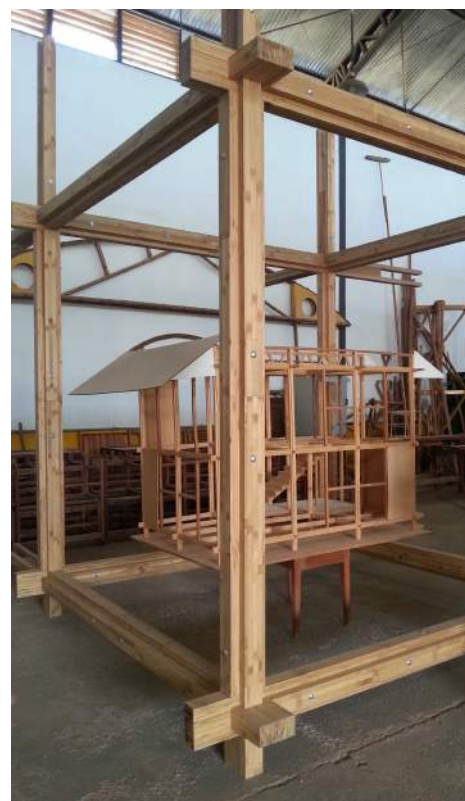
Protótipo 1:1 em bambu laminado colado
