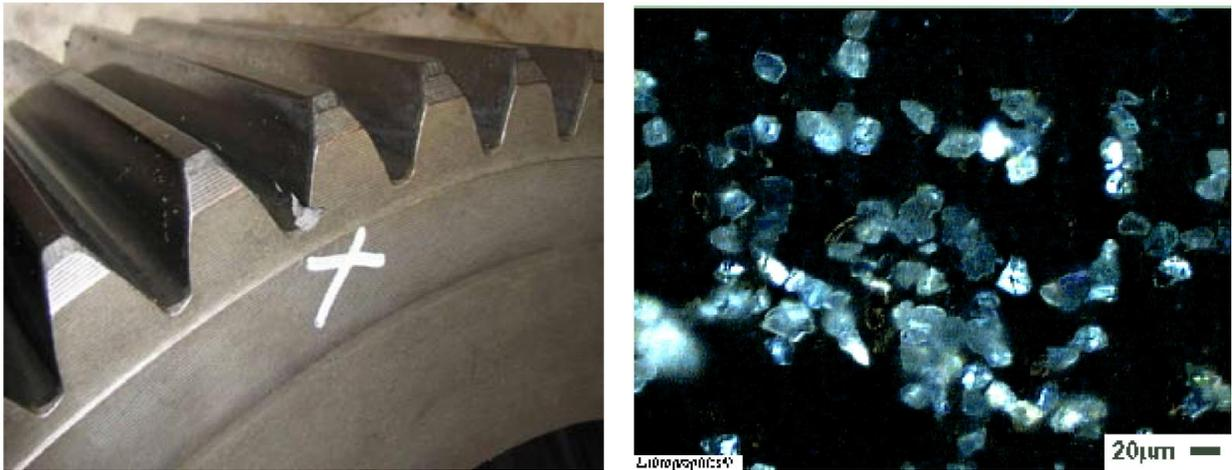
Figura 5.12 - Fratura no dente da engrenagem (a esquerda) e contaminação do óleo lubrificante (a direita) (Sheng et al., 2011).
