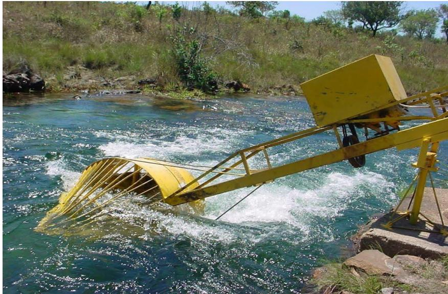
Figura 1.3 - Protótipo de Turbina Hidrocinética desenvolvido pela UnB (Tiago, 2003)
