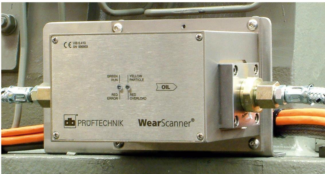
Figura 6.13 - Contador de partículas de óleo VIB 6.411 SET - WEARSCANNER (Pruftechnik, 2014).
