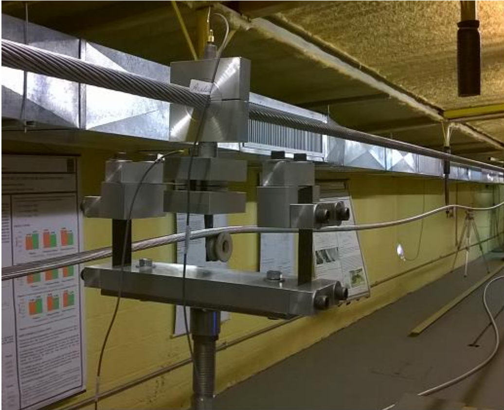
Figura 30 - haste atuadora do shaker e braçadeira utilizada para conectar o cabo condutor ao shaker .
