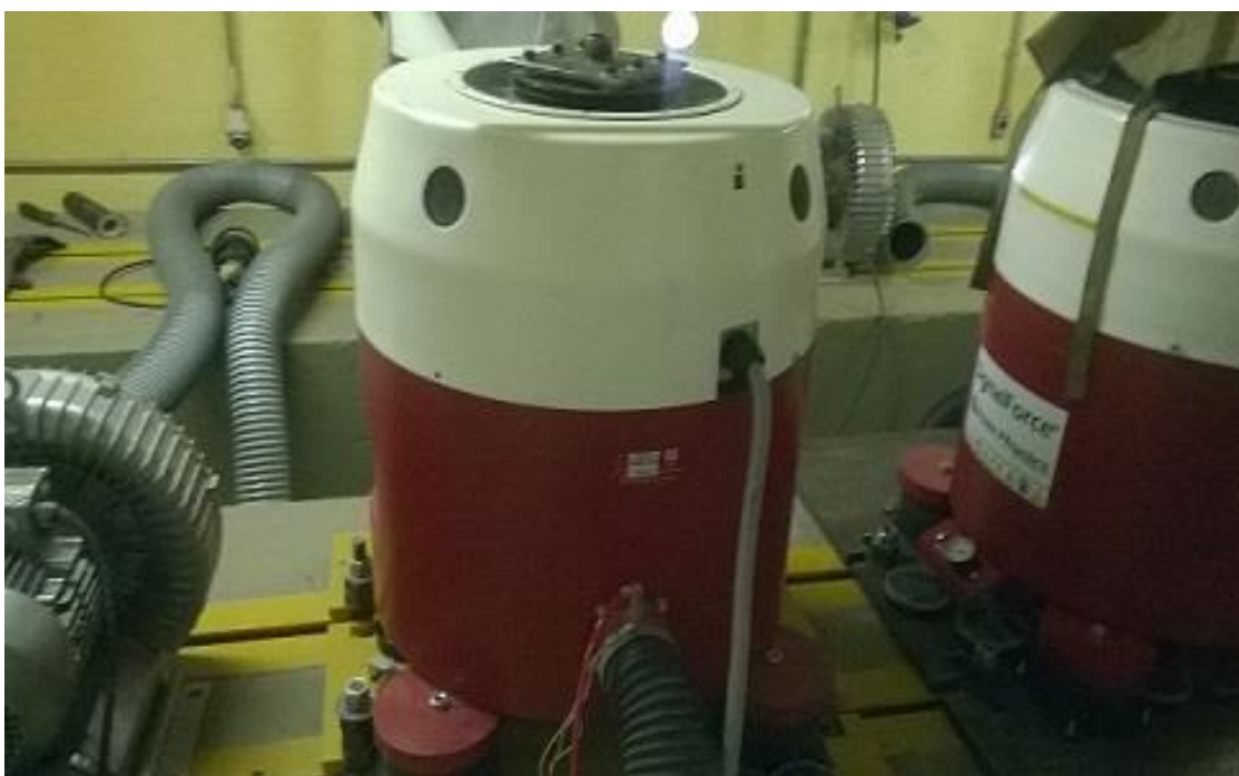
Figura 29 - Foto ilustrativa do excitador Eletrodinâmico GW-V400/DSA5-10K ( shaker ).
