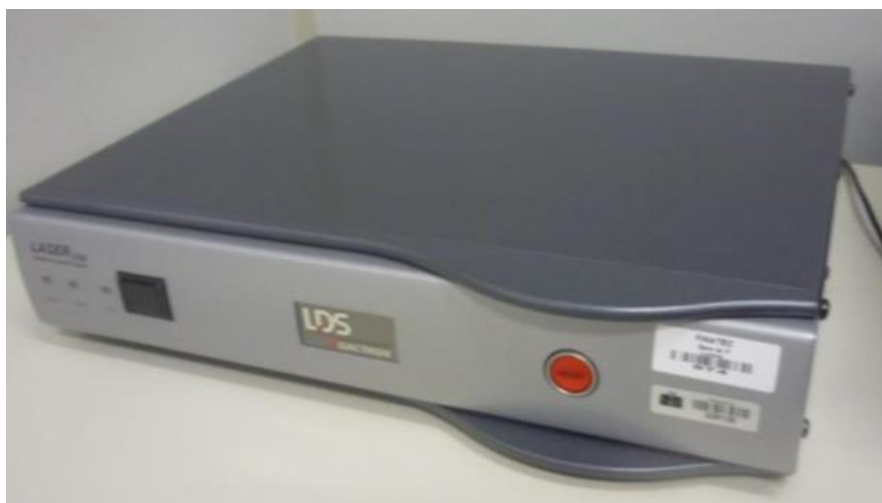
Figura 31 - Foto ilustrativa do sistema para controle vibracional LDS LASER USB LAS-200.
