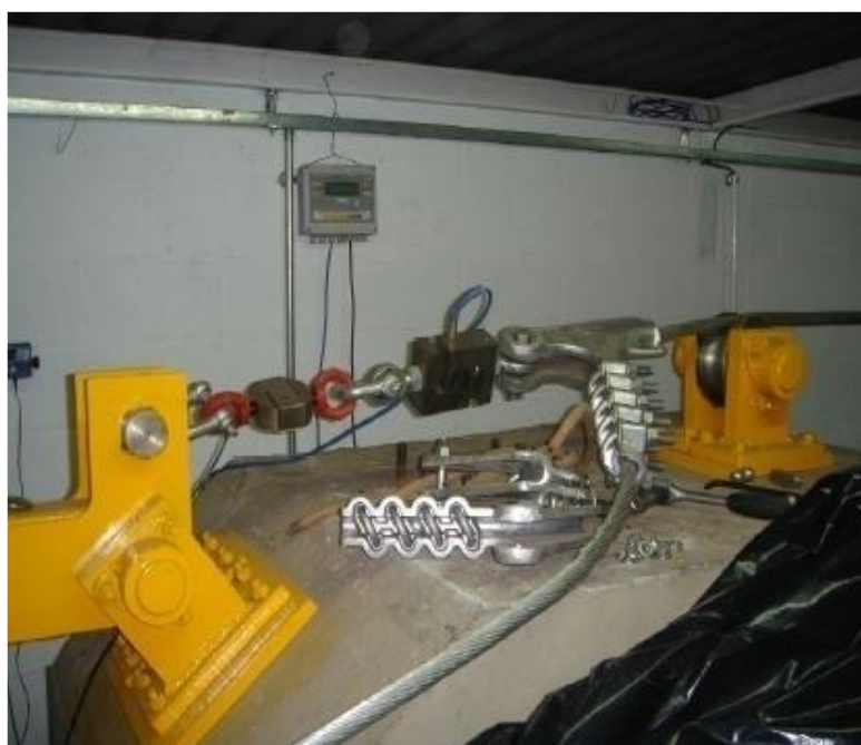
Figura 28 - Célula de carga (à esquerda, entre as argolas vermelhas) e seu calibrador (à direita) (Murça & Kage, 2009).
