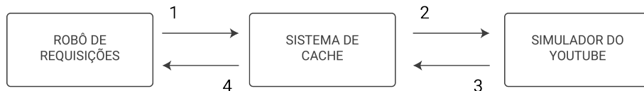
Figura 5.1: Comunicação entre o sistema de cache e os programas auxiliares desenvolvidos.
