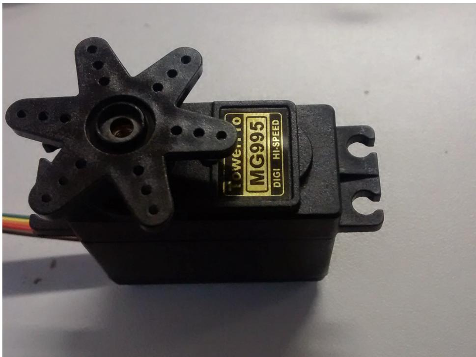
Figura 53 – Servo utilizado.
