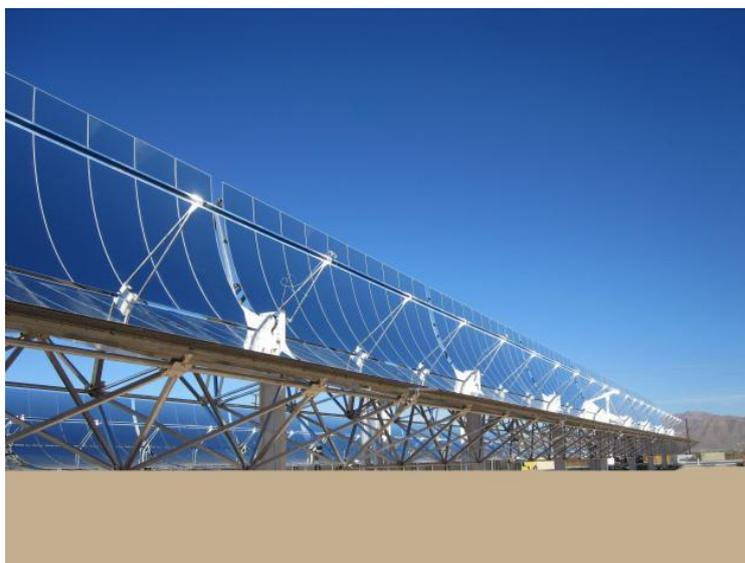
Figura 9- Coletor Canal Parabólico. Fonte: Sun & Wind Energy. Disponível em < <http://www.sunwindenergy.com/news/new-parabolic-trough-collector-3m-and-gossamer> > Acesso maio 2014.
