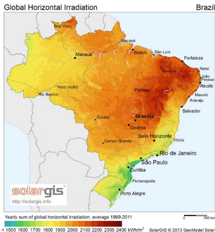
Figura 5- Mapa de irradiação solar global no Brasil. Fonte: SolarGIS, disponível em <<http://solargis.info/doc/free-solar-radiation-maps-GHI>> Acesso em junho 2014.
