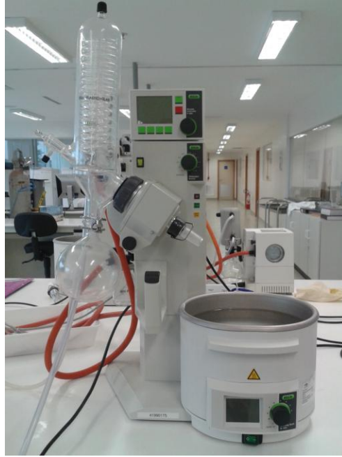
Figura 15 -Rotaevaporador a vácuo com chiller Marca Büchi R-210 utilizado na secagem do biodiesel.
