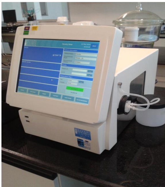
Figura 7- Densímetro Digital utilizado na análise de densidade. Fonte: Autora.
