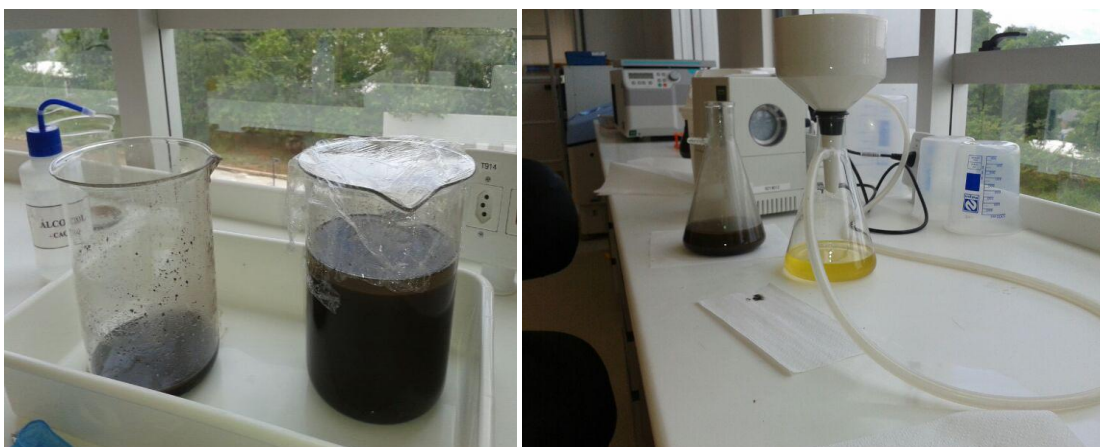
Figura 5 -Processo de filtração do óleo bruto para obtenção do óleo de baixa acidez.
