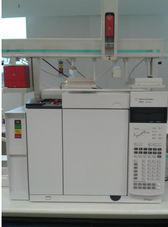
Figura 16- Cromatógrafo à gás utilizado no teor de éster. Fonte: Autora.
