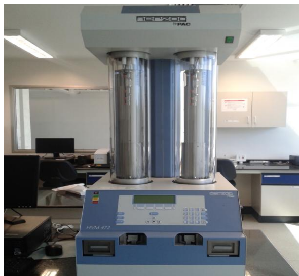
Figura 6- Multiviscosímetro utilizado na análise de viscosidade. Fonte: Autora.
