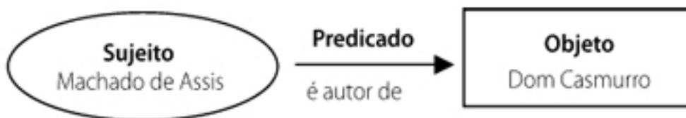
Figura 2.4: Estrutura da Tripla RDF
