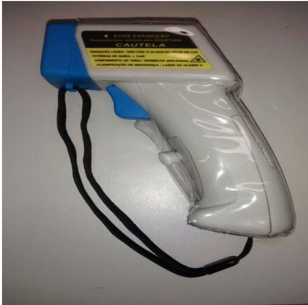
Figura 02 - Termômetro Digital utilizado para as medições térmicas. Acervo do autor
