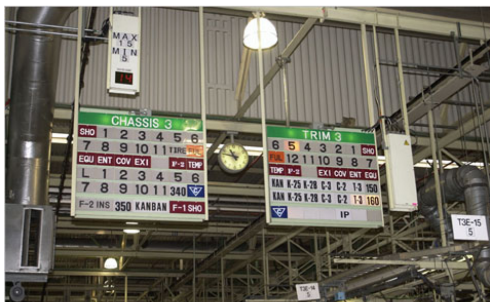
Figura 37 – Quadro Andon, com o mesmo objetivo do Kanban, na fábrica da Toyota (WILLIAMS, 2009)
