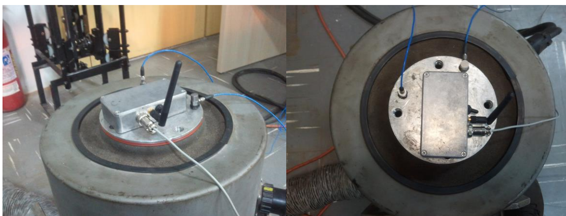
Figura 55 – Acelerômetros instalados no Shaker .
