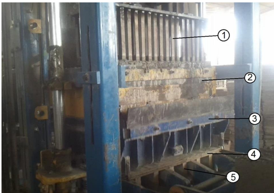
Figura 10 – Enchimento da forma dos blocos.
