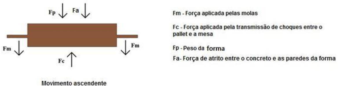
Figura 18 – Vista frontal da forma - Diagrama de corpo livre (vibração vertical).
