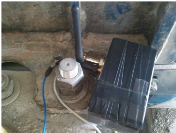
Figura 69 – Protótipo do Acelerômetro desenvolvido e o PCB 352C03 instalados lado a lado na aba da forma.
