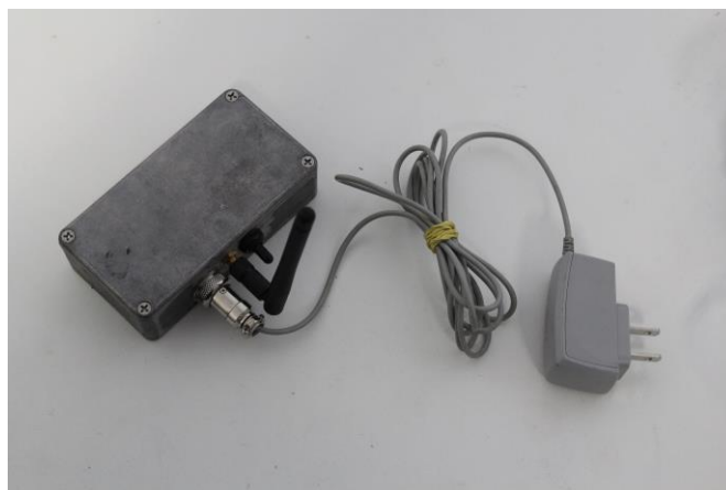
Figura 53– Protótipo do acelerômetro com a fonte de alimentação.
