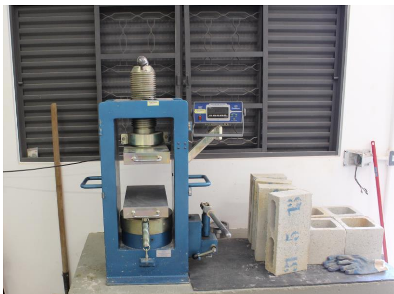
Figura 43- Máquina utilizada para o ensaio de compressão dos blocos.
