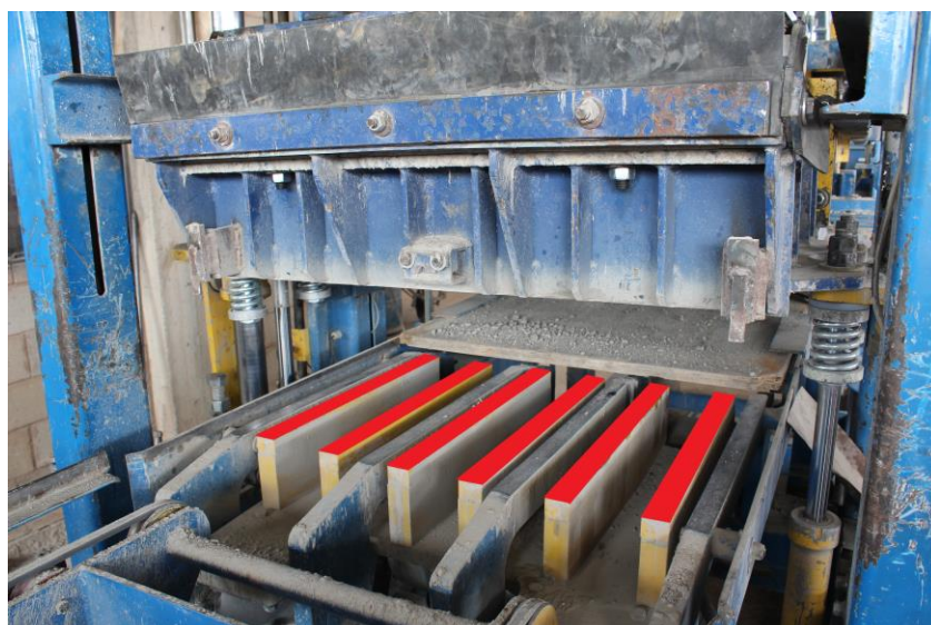
Figura 37– A região marcada em vermelho representa a área da grelha que entra em contato com o pallet ( A_m ).
