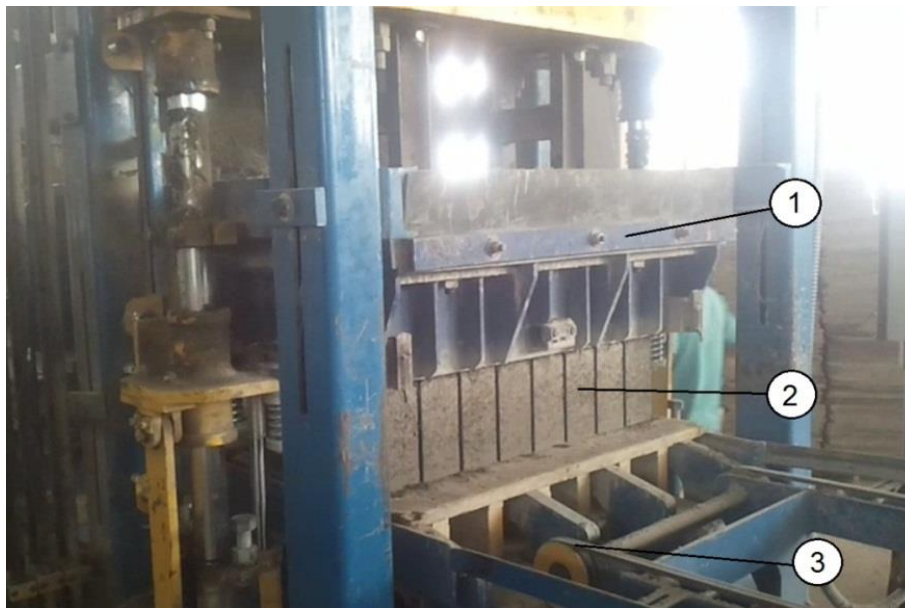
Figura 12 – Subida da forma e retirada dos blocos.
