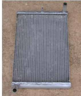
Figura 4.16 Radiador pronto para teste
