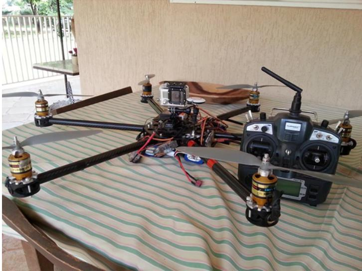
Figura 30 – Hexamotor com a câmera em cima do aparelho.
