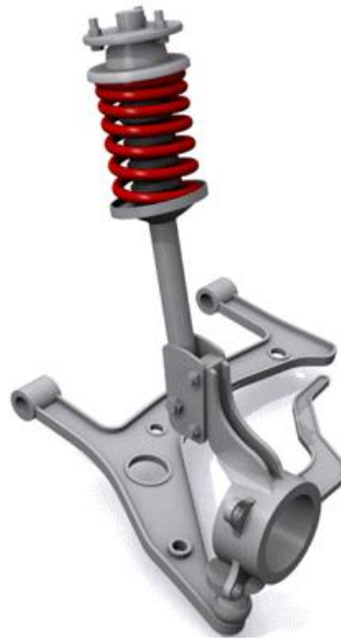
Figura 2 – Suspensão Mac Pherson (Valdeck, 2007)
