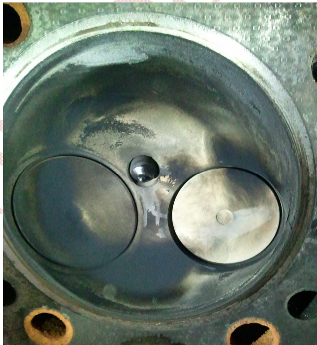
Figura 32 - Válvulas e bico 2
