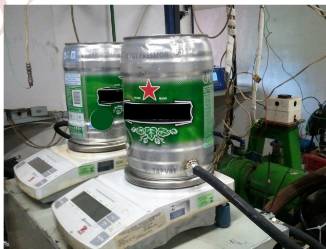
Figura 7 - Aparato experimental - armazenamento do combustível
