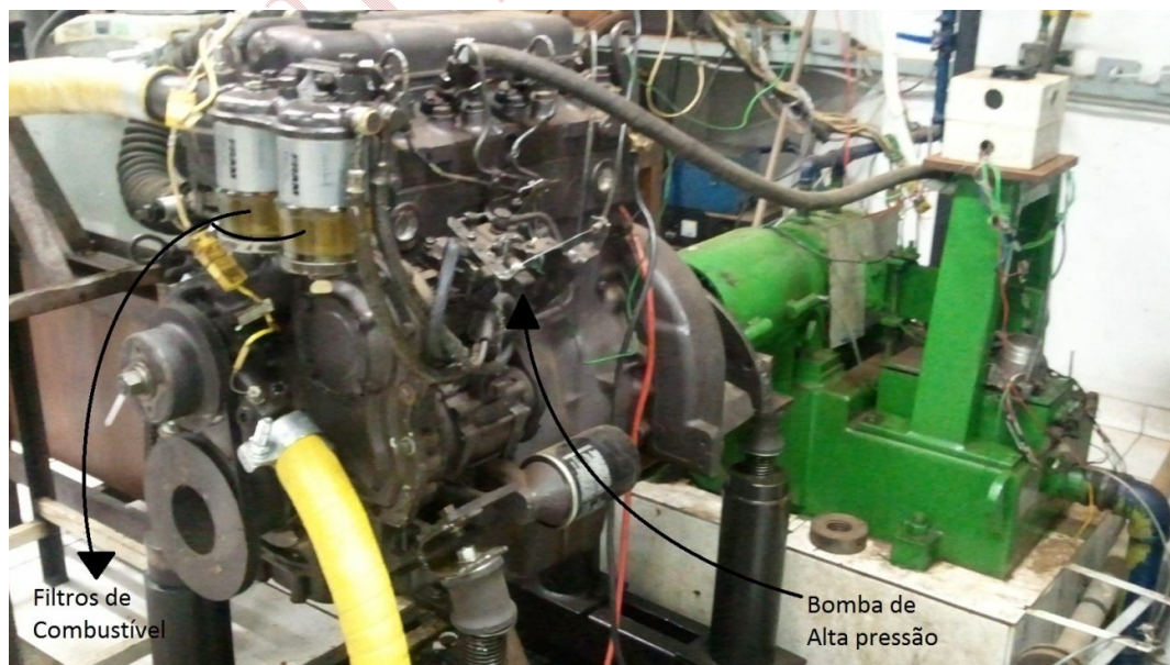
Figura 9 - Aparato experimental - motor e dinamômetro montados
