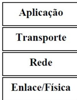
Figura 2.2: Pilha TCP/IP.
