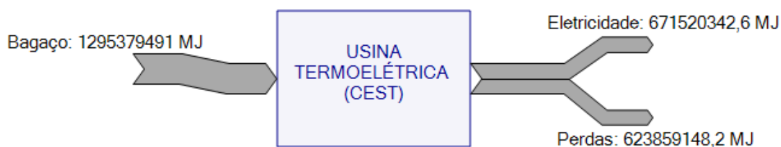
Figura 27. Fluxo energético da usina termoeletrica (CEST). Fonte: Elaboração própria com base nos dados de Seabra e Macedo (2010).
