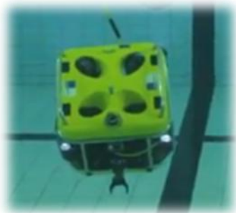
Figura 5. Ocean Module V8 Sii ROV, um exemplo de ROV com estrutura caixa.
