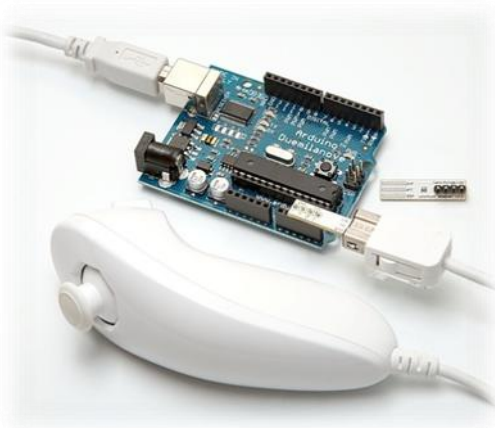
Figura 60. Ilustração da ligação Arduino-Nunchuck
