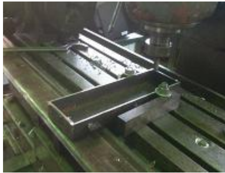
Figura 49. Operação de faceamento da cápsula na fresa
