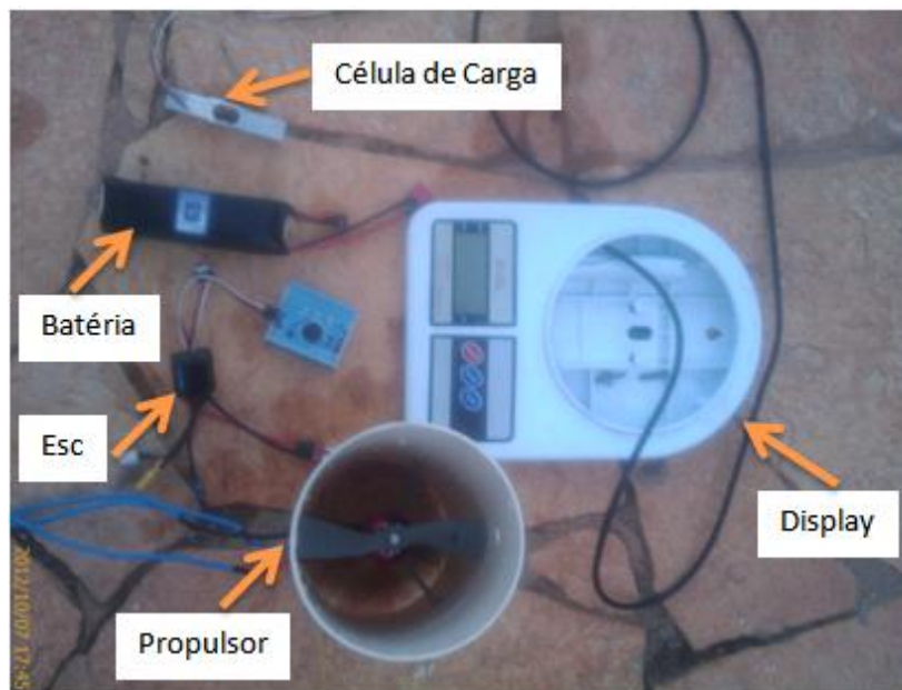
Figura 35. Elementos da medição de empuxo do propulsor
