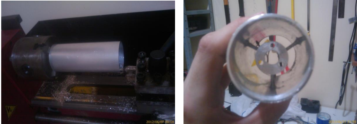
Figura 30. Processo de recartilhamento da envoltória de alumínio e o novo suporte do motor.
