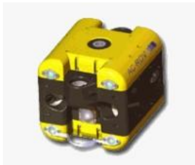
Figura 4. AC ROV 100, um exemplo de ROV com estrutura cúbica.
