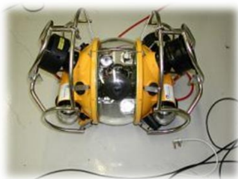
Figura 6. EyeBall ROV, um exemplo de ROV com estrutura esférica.
