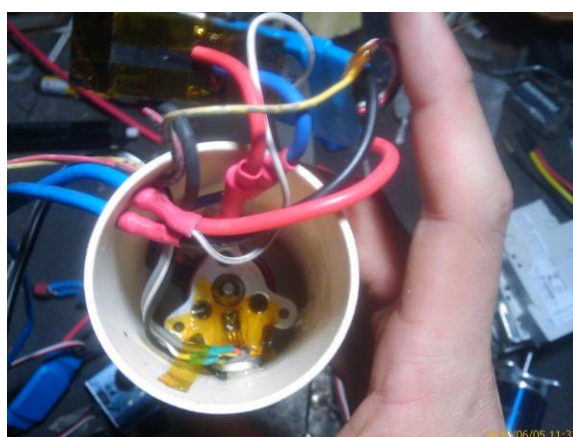
Figura 27. A inserção do sensor de temperatura no suporte do motor
