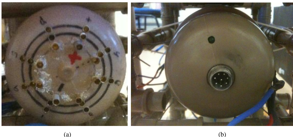
Figura 47. (a) Tampa com conexões bullets e (b) DIN metálico
