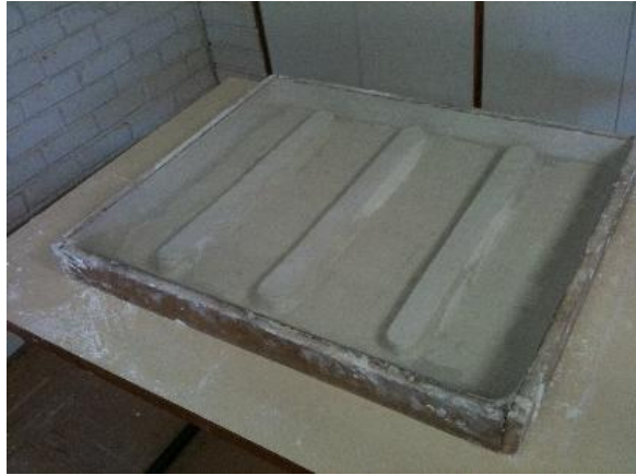
Figura 53. Molde para fabricação das bases
