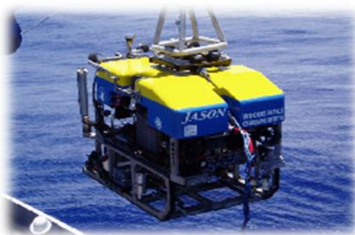
Figura 7. ROV Jason, um exemplo de ROV classe Worker.
