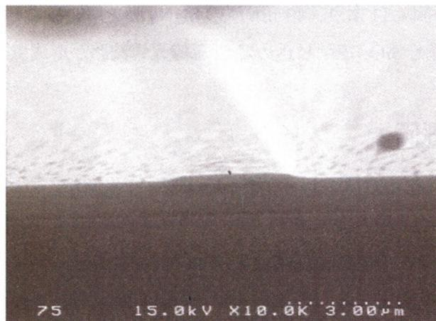
図 4.11: 7時間酸化後、希フッ酸処理により酸化膜を除去したデバイスの SEM 画像
