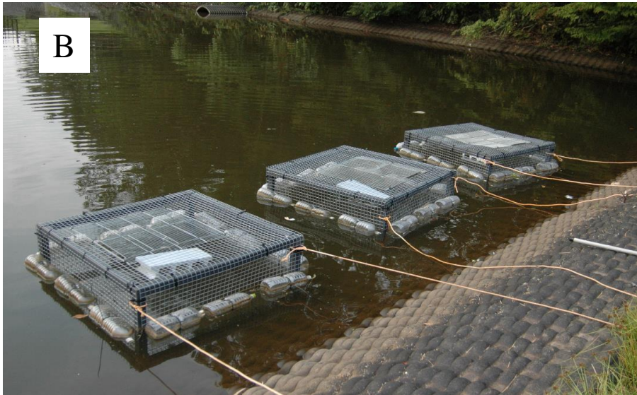
図5 A 野外飼育実験の装置の概要図。金網を張ったケージに浮きを付け、水面に浮かべた。ケージ内にはバスキング（日光浴）用の浮島を設置した。 B 野外に設置した図。3基を能美市いしかわ動物園内の調整池に設置した。
