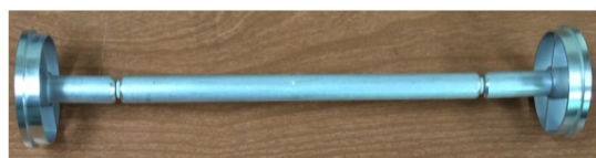
図5. 二重連結領域実験用中心電極
