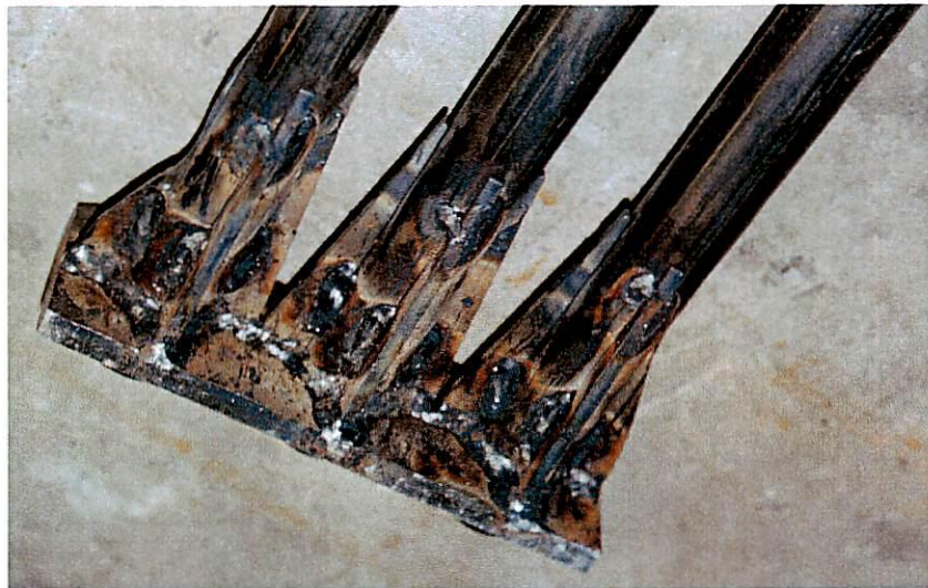
写真 2.2 羽根付き角形アンカープレート (T27-Type)
