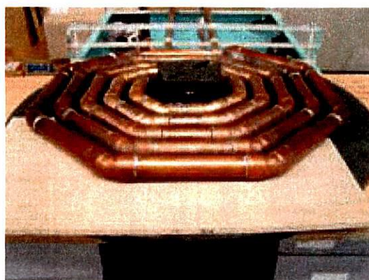
図 5.1: フェライト・コアを付加させた誘導コイル
