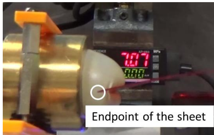
図 3.2-8 計測に使用したシートの端点
