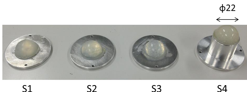
図 2.2-1 作成した半球状指 (S4のみ固定部品が異なる)
