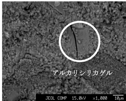
写真 2.3.7 電子顕微鏡観察による アルカリシリカゲルの同定
