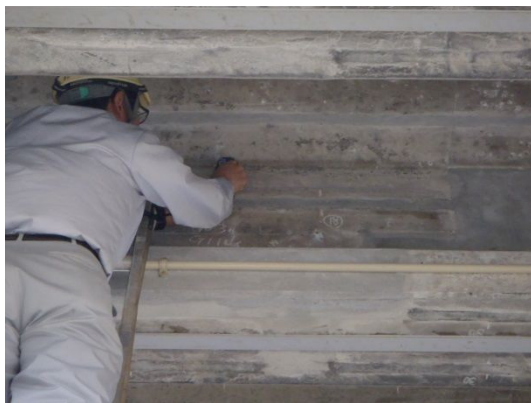
(b) G 橋 コンタクトゲージによるひび割れ幅の測定状況
