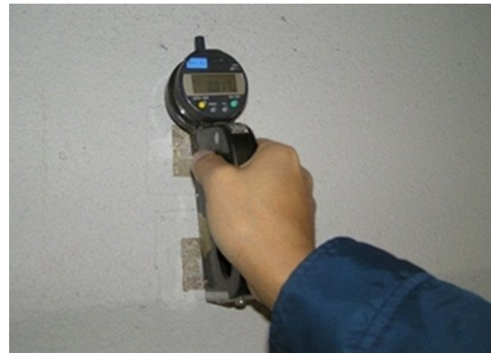
(a) E 橋 コンタクトゲージによるひび割れ幅の測定状況
