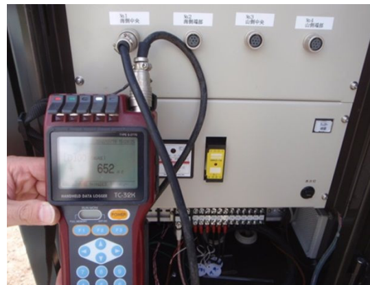
(b) J 橋 亀裂変位計によるひび割れ幅の測定状況
