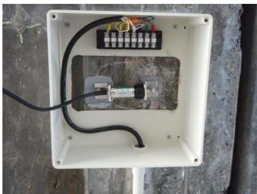
(c) K 橋 亀裂変位計によるひび割れ幅の測定状況
