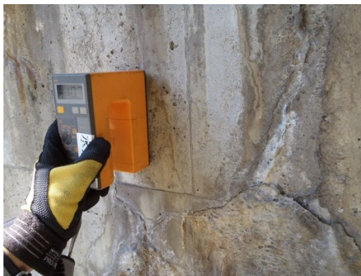
写真2.3.4 高周波表面水分計による覆工コンクリート表面の測定
