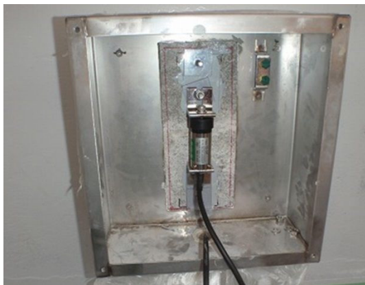
(b) J 橋 亀裂変位計によるひび割れ幅の測定状況
