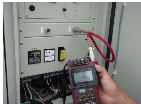
(c) K 橋 亀裂変位計によるひび割れ幅の測定状況
