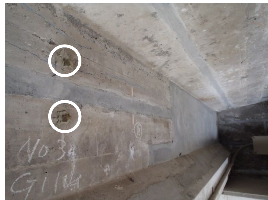
(b) G 橋 コンタクトゲージによるひび割れ幅の測定状況
