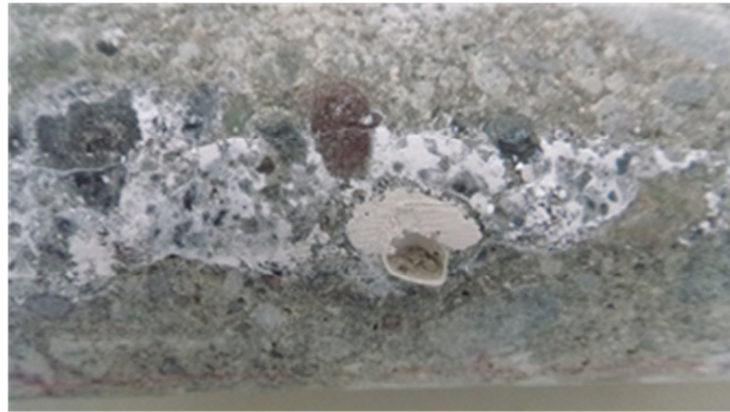
写真 4.3.8 水中部の採取コア（水中-1） （アルカリシリカゾルが空気に接触しゲル化したもの）
