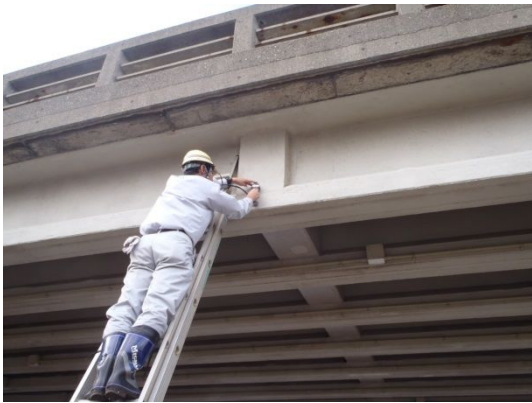
(a) E 橋 コンタクトゲージによるひび割れ幅の測定状況
