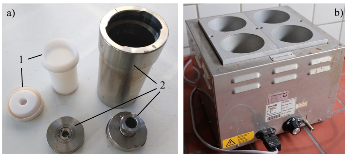
Abbildung 5.13.: Apparatur für die Hydrothermalsynthese. a) Teflonreaktionsgefäß mit Deckel (1) und Edelstahl Druckbehälter mit Verschluss (2) ; b) Heizblock.
