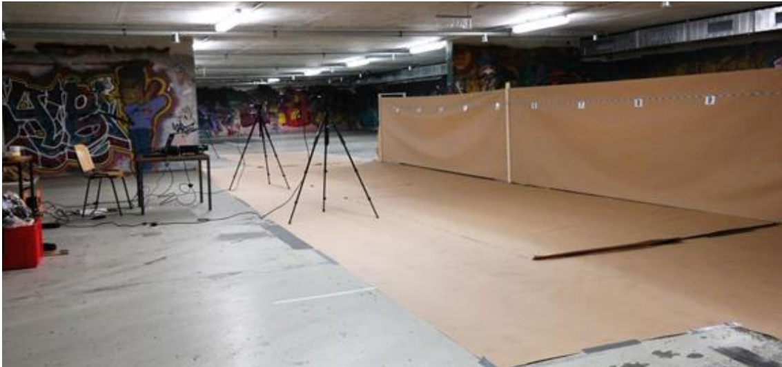
Abbildung 6. Übersichtsaufnahme der Laufstrecke im unteren Parkdeck Parkhauses des Universitätsklinikums Homburg. Unmittelbar neben der Laufstrecke, zwischen Meter 5 und Meter 6, wurde eine auf einem Stativ angebrachte Videokamera zur Dokumentation der Durchgänge aufgestellt.
