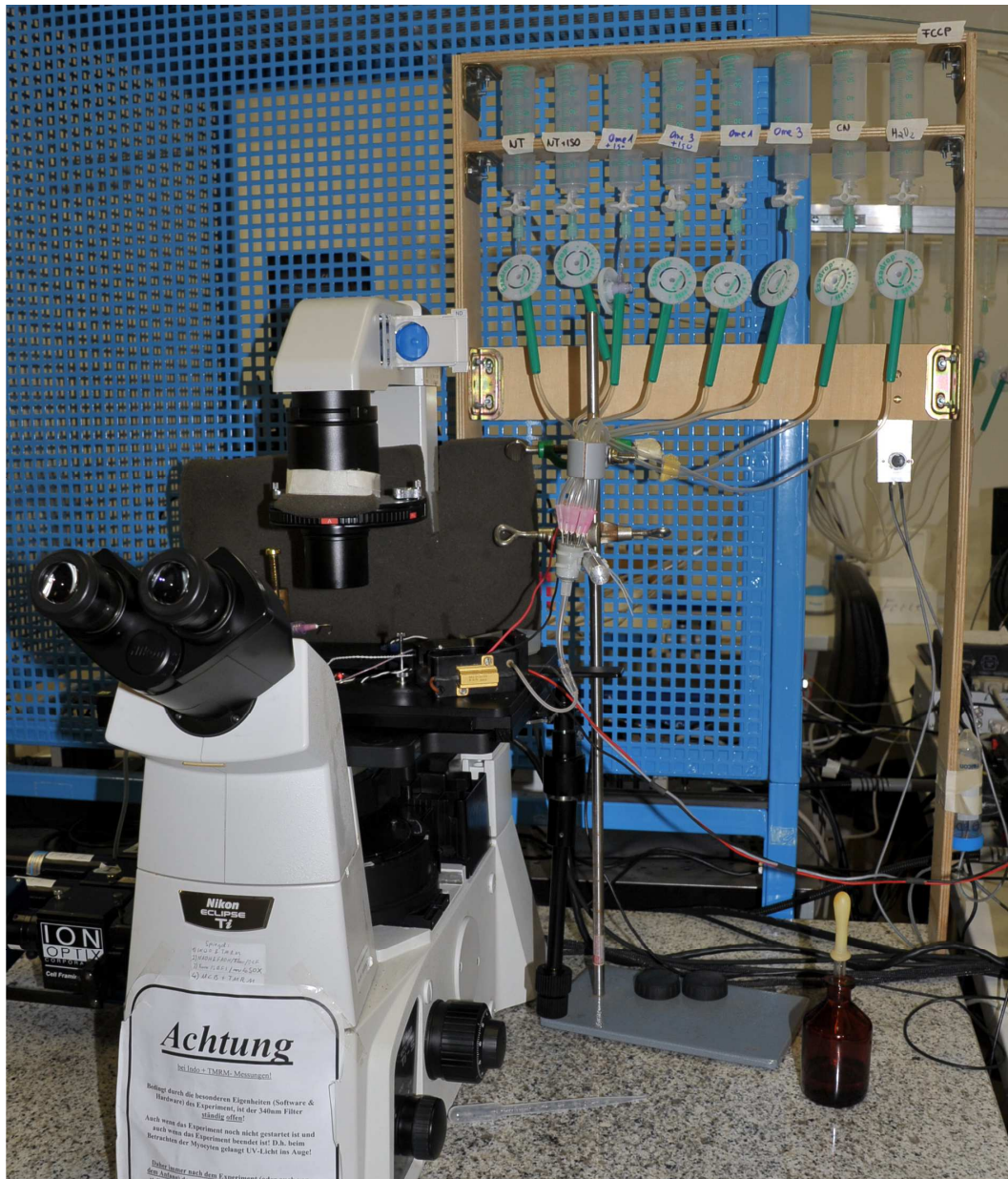
Abbildung 9: Aufsichtfluoreszenzmikroskop und zuführende Gefäße zur Zugabe der verschiedenen Lösungen
