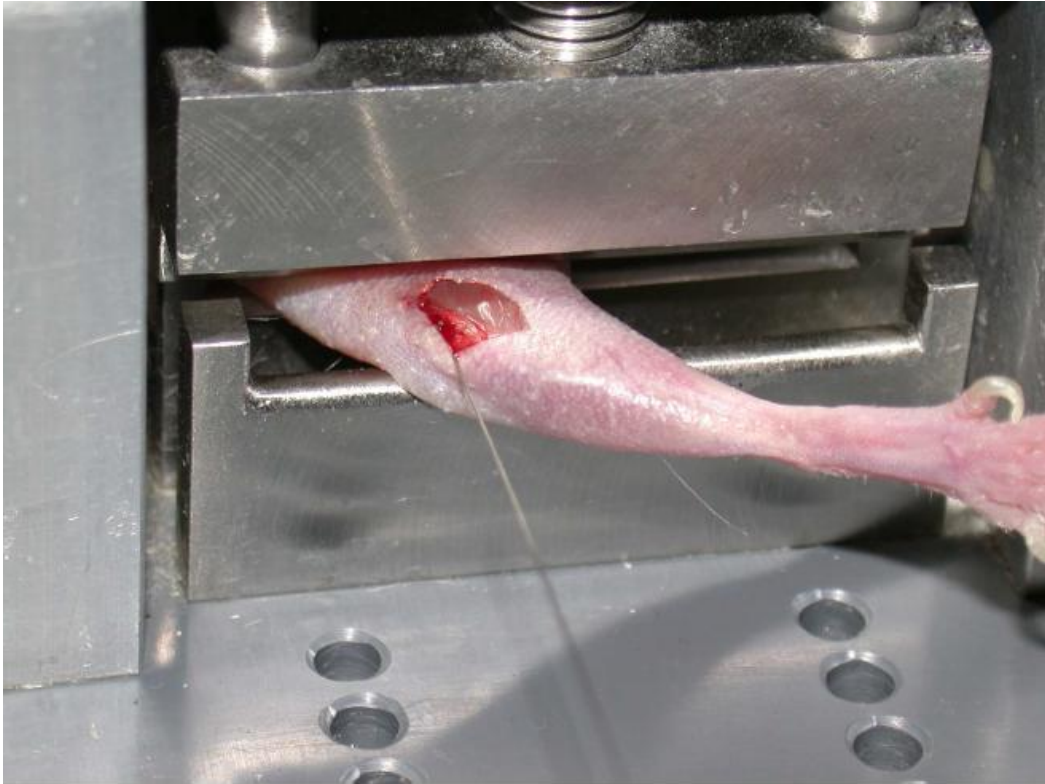
Abb. 11: Positionierung des Beines in der Frakturapparatur (KLEIN, 2008)
