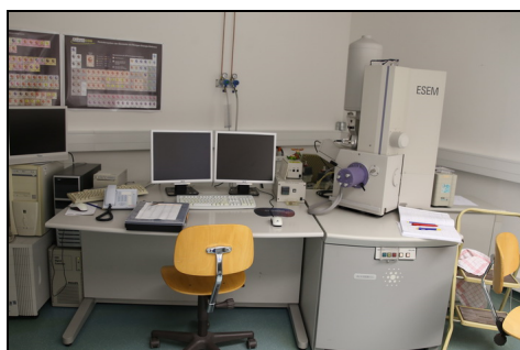
Abb. 16 Rasterelektronenmikroskop XL 30 ESEM FEG
