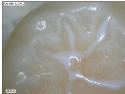
Abb. 40 Lichtmikroskopische Darstellung einer Probestentseite nach 28 d Inkubation in PCE-Lösung bei 37 °C, Originalvergrößerung 50-fach
