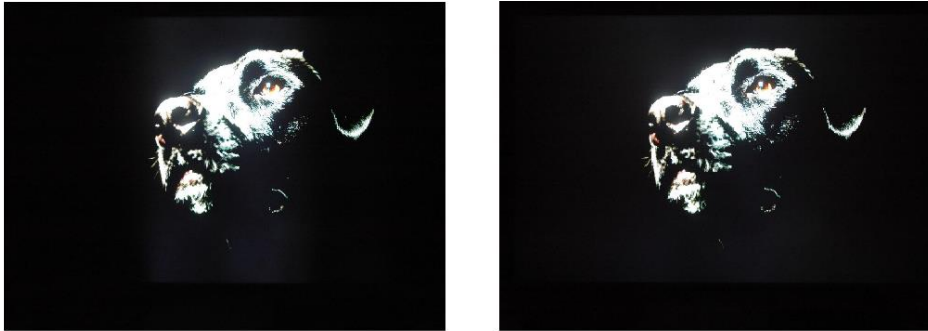
Abbildung 4-20: Verringertes Halo durch LED Faktoren; links starkes Halo ohne Faktoren; rechts: stark reduziertes Halo bei einem Faktor von 1,4 [Gru16]
