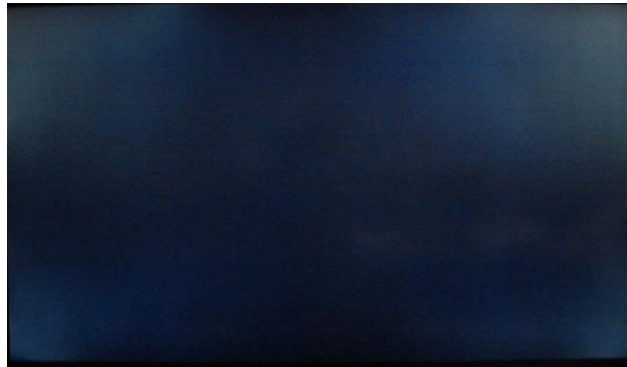
Abbildung 4-11: Clouding eines Edge-Lit-TVs mit LEDs an beiden kurzen Displaykanten
