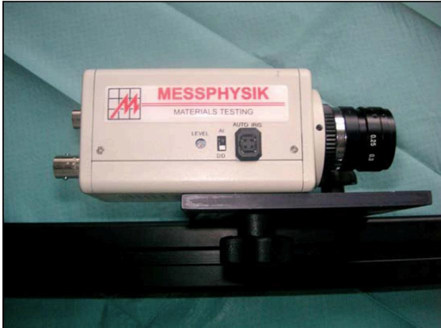
Abbildung 13: „Vollbild-Videotextensometer ME 46“ (Messphysik Laborgeräte Ges.m.b.H., Fürstentfeld, Österreich)
