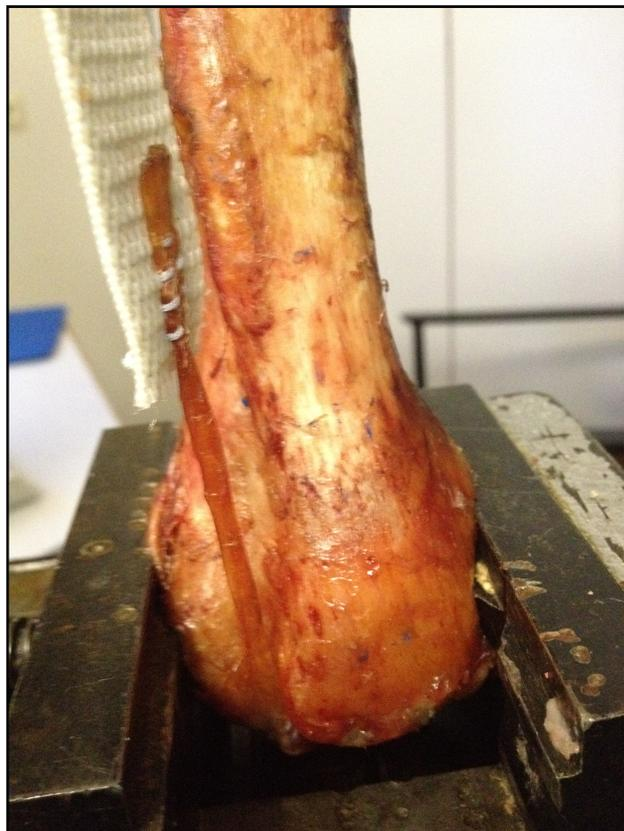
**Abbildung 23: Montage des Präparats in der Materialprüfmaschine. Der Humeruskopf ist in der Schraubklemme, das hochvernetzte Kunststoffband im Bereich der beweglichen Traverse fixiert.**
