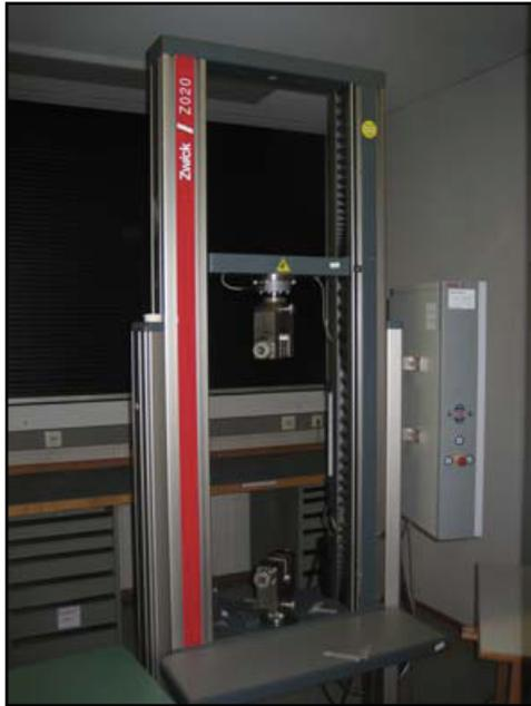
**Abbildung 12: Universalmaterialprüfmaschine (Modell: BTC-FR020TH.A50, Zwick GmbH & Co KG, Ulm, Deutschland)**
