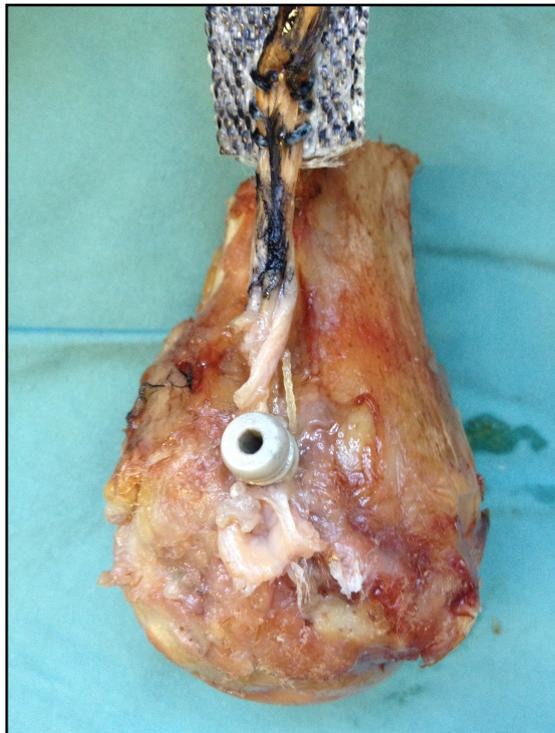
**Abbildung 29: Herausgleiten der Sehne aus dem Knochentunnel beim 8-mm Peek-SwiveLock-Anker**
