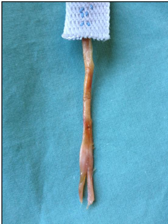
**Abbildung 27: Versagen der Sehnen-Faden-Verbindung beim armierten 5,5-mm Peek-Corkscrew-Anker. Der Faden hat sich längs durch die Sehne geschnitten.**
