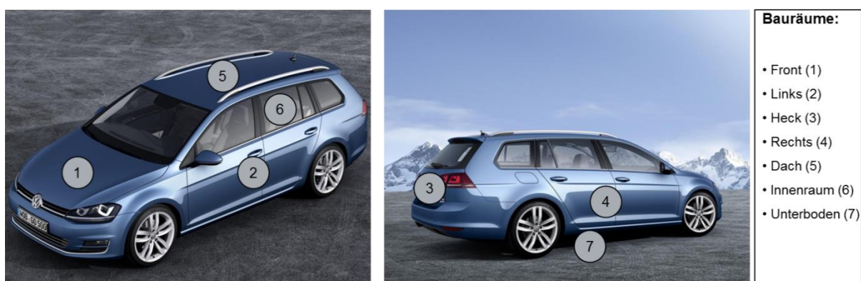
Abbildung 4-2: Mögliche Bauräume in einem Fahrzeug [WEID15, S.229]
