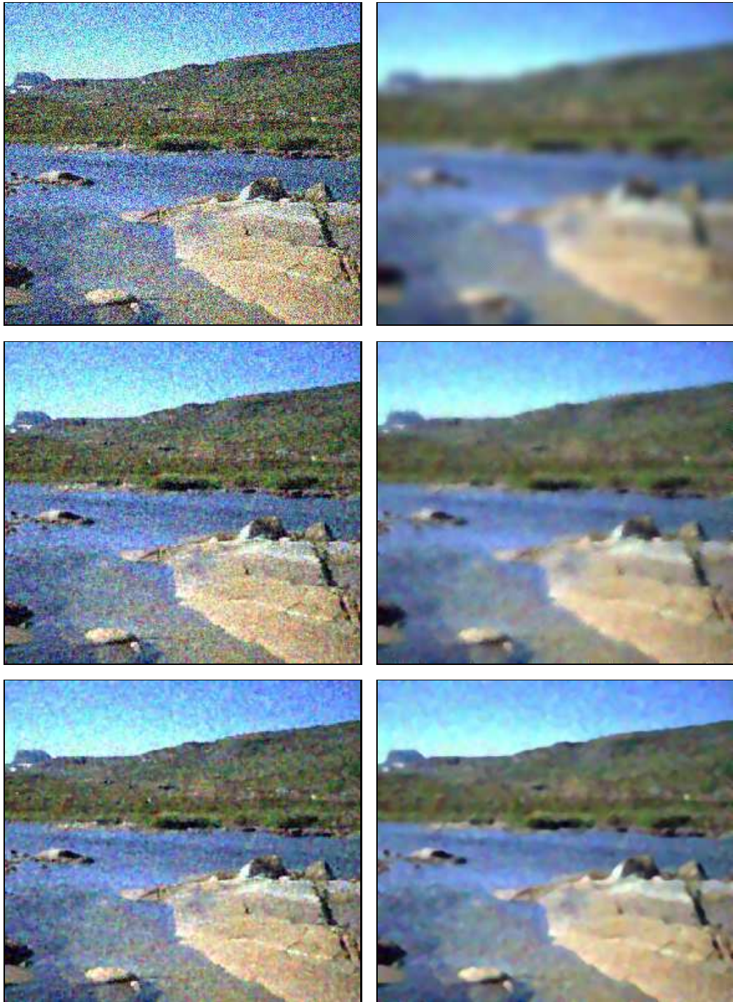
Figure 5: Diffusion filtering of colour images. (a) Top left : Noisy color image. (b) Top right : Homogeneous diffusion. (c) Middle left : Linear isotropic diffusion. (d) Middle right : Linear anisotropic diffusion. (e) Bottom left : Nonlinear isotropic diffusion. (f) Bottom right : Nonlinear anisotropic diffusion. From [89].
