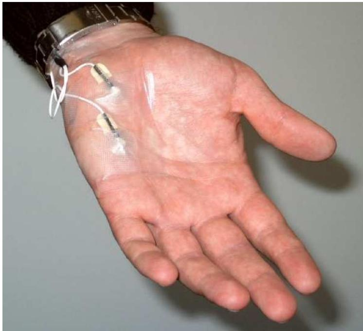
Abbildung C.9: EDA-Sensor an Handinnenfläche mit Zugentlastungsschleife
