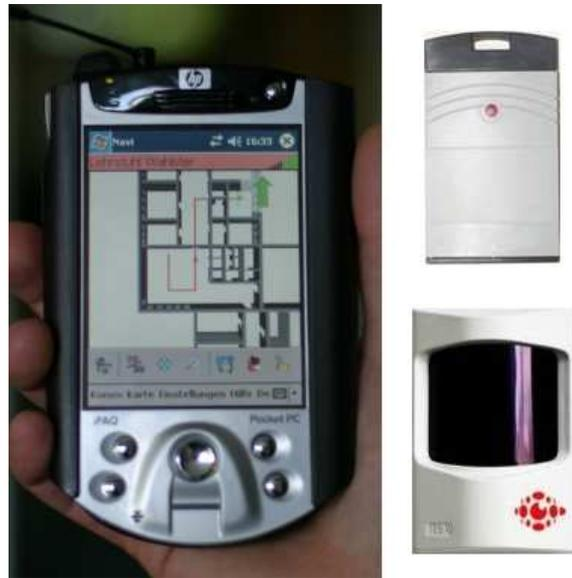
(b) iPAQ mit PCMCIA RFID-Lesegerät, eingebautem WLAN und IR-Sensor (links) und RFID-Tag und IR-Beacon (rechts)
