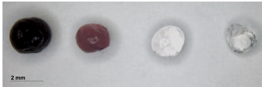
Abb. 8.4. Alginat-Phantome mit unterschiedlichen Konzentrationen an Nanorods. Von links nach rechts: 1,5 \cdot 10^{12} /ml , 3 \cdot 10^{11} /ml , 3 \cdot 10^{10} /ml , Kontrolle (reines Alginat)
