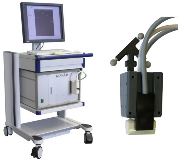
Abb. 6.11. DiPhAS mit integriertem PC. Kombiniertes Wandler mit optischen Trackern zur 3-dimensionalen Bildgebung
