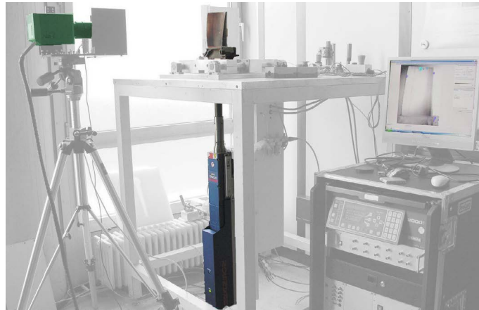
Abbildung 2.1: Eine bei Siemens entwickelte Prüfanlage zur Inspektion mit der akustischen Thermografie (SIEMAT).
