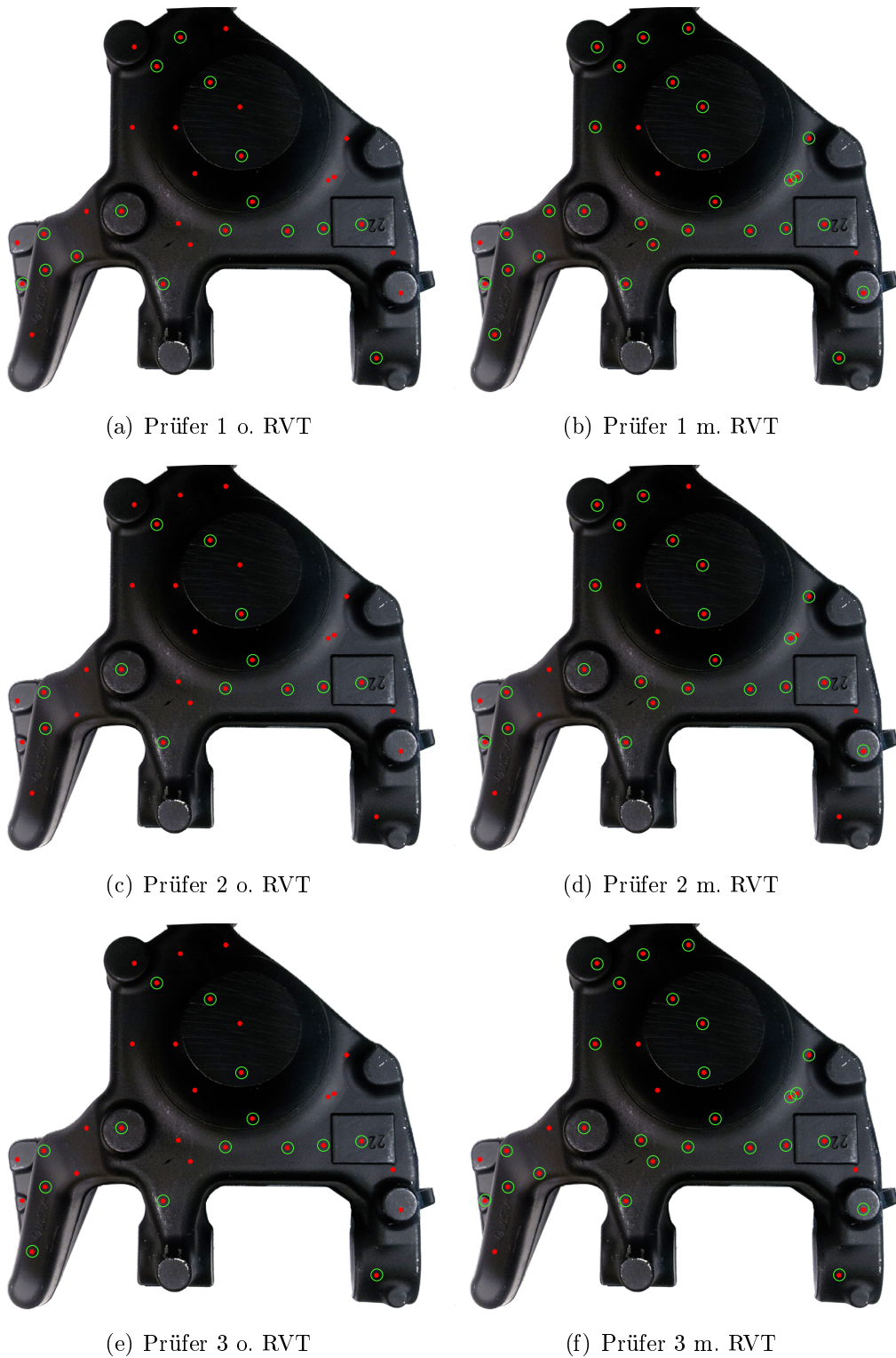
Abbildung 5.15: Darstellung der durch die drei Prüfer gefundenen Defekte (grün markiert) ohne (links) und mit dem RVT-Verfahren (rechts) bei der Untersuchung eines Rad-aufhängers.
