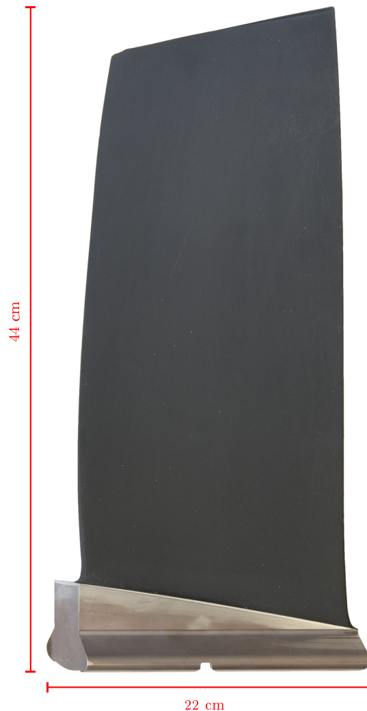
Abbildung 4.9: Abbildung einer Verdichterschaufel. Die eingebrachten Bohrungen wurden mit einer Spachtelmasse ausgefüllt und die Oberfläche des Prüflings geschwärzt. Die Präparation ist somit auf der Oberfläche nicht sichtbar.
