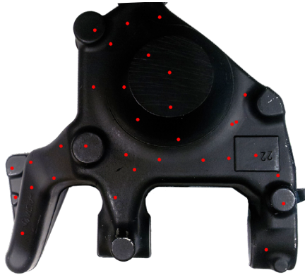
Abbildung 4.8: Verteilung der präparierten Bohrungen mit einem Durchmesser von 1,8 mm und einer Tiefe von 2 mm. Die Bohrungen sind mit einer Spachtelmasse ausgefüllt und das Bauteil mit einer Graphitschicht versehen, um die thermische Emissivität zu erhöhen. Die Bohrungen sind somit nicht sichtbar.
