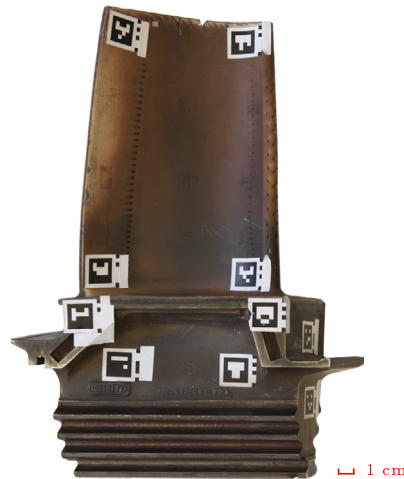
Abbildung 4.33: Abbildung einer Gasturbinenschaufel mit den aufgebracht binär-kodierten Markern für das Tracking-Verfahren.
