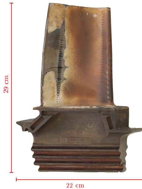
Abbildung 4.6: Abbildung einer in dieser Arbeit verwendeten Gasturbinschaufel. Diese weist viele im Betrieb entstandenen Defekte (Risse, Delaminationen und Verschmutzungen) auf und ist dadurch für eine Analyse der Klassifikationsgenauigkeit der Defekte gut geeignet (Abschnitt 5.1).
