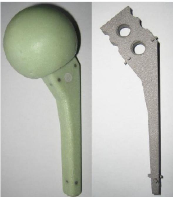
**Abbildung 3: Spacer und Titanendoskelett**
