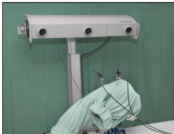
Abb. 4: Kameraeinheit und am Modell fixierte Referenzbasen
