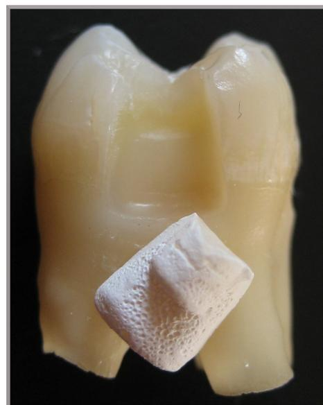
Abb. 36: Verlust der GIZ-Füllung nach wenigen Zyklen im Kausimulator
