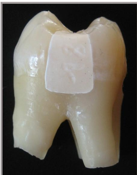
Abb. 35: GIZ-Füllung vor thermo-mechanischer Belastung
