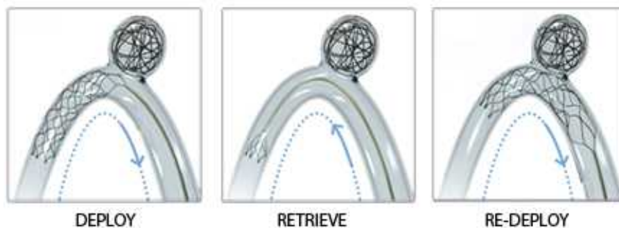
Abb. 14: Veranschaulichung der Repositionierbarkeit des elektrolytisch ablösbaren Stents der Firma eV3. Quelle: eV3, http://www.ev3.net/neuro/intl/neurovascular-stents/solitaire-ab.htm ; 12.08.2009
