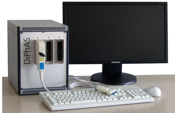
Abb. 7.3. Gehäuse der integrierten DiPhAS Hardwareplattform inkl. Computer
