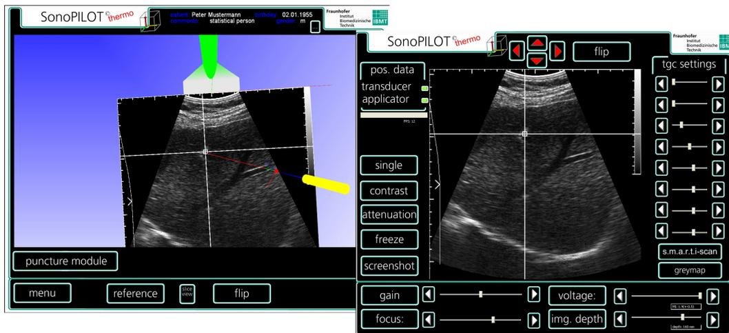
**Abb. 8.16.** Benutzeroberfläche der Navigation des SonoPilot thermo, 3d-Ansicht der Messschicht mit koregistrierter Darstellung des Punktionskanals und Applikatorposition
