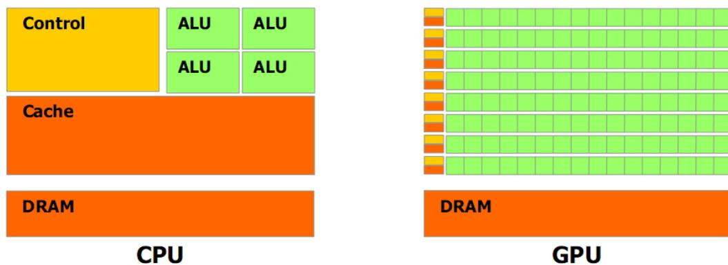
**Abb. 6.3.** Architektur eines Prozessors mit wenigen Rechenwerken (ALU’s) (links) im Vergleich zur Architektur einer hochparallelen Grafikkarte mit vielen Rechenwerken (rechts), Darstellung: NVidia
