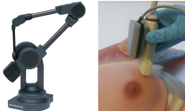
**Abb. 2.11.** Mechanisches Trackingsystem microScribe (Quelle: Immersion Corp., links), Inertial-sensorik der Fraunhofer TEG (rechts)
