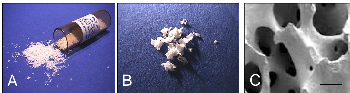
Abbildung 7: Die Hydroxylapatit-Keramik Cerabone. A) Darreichungsform von Cerabone Granulat F: Korngröße 0,5-1,6mm. B) Cerabone Granulat, drei bis vier dieser Granula wurden jeweils in eine Rückenhautkammer implantiert. C) Mikroskopische Aufnahme von Cerabone, man erkennt die interkonnektierenden Poren, die unterschiedliche Größen aufweisen. (Skalierung = 1000µm)
