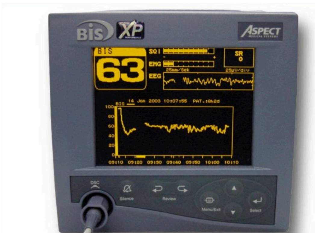
Abb. 15: Der BIS-A-2000-Monitor im klinischen Einsatz bei einer balancierten Anästhesie [modifiziert nach[5]]. Der BIS Wert ist oben links dargestellt. Im unteren Teil des Bildschirms kann man den Verlauf des BIS-Wertes über einen Zeitraum von einer Stunde verfolgen. Oben rechts: Angabe von SQI(= Signal Quality Index; Prozentsatz der gut abgeleiteten und gemessenen Phasen der letzten 60 s), EMG(= EMG-Anteil am BIS-Wert), EEG(= Darstellung des Roh-EEG) und SR(=“Suppression Ratio“).
