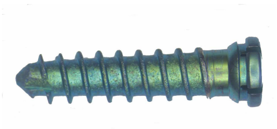
Abb. 3: Seitliche Ansicht einer ABC-Standardschraube . Die Schraube hat einen konischen Kerndurchmesser, von 2,2 mm an der Spitze ansteigend auf 2,7 mm am Kopf. Die Schraube ist selbstschneidend.
