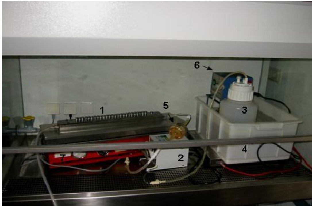
Abbildung 3 Versuchsaufbau: 1 Robbins Device 2 Schlauchpumpe 3 Polypropylenflasche mit Nährlösung 4 Transportbehälter 5 Filterhalter 6 Einhänge-Thermostat 7 Heizbank
