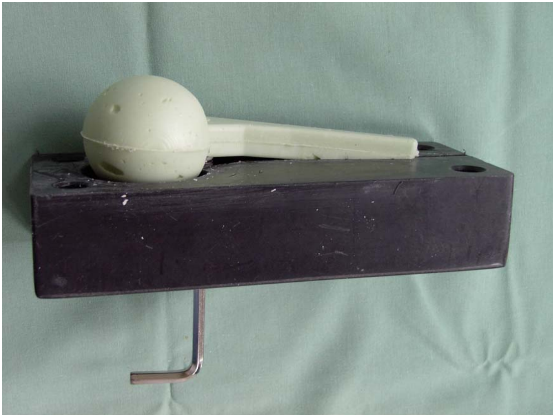
Abb.8: Ausgehärteter Spacer wird aus der Gussform herausgehoben.
