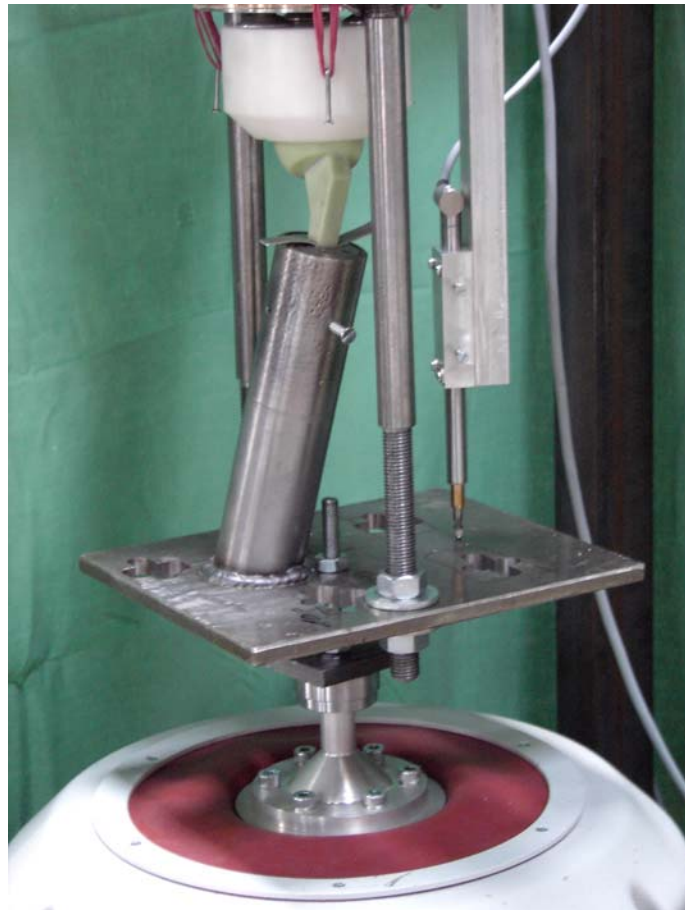
Abb.12: In die TIRA-Prüfmaschine eingespannter Spacer vor der Testung.
