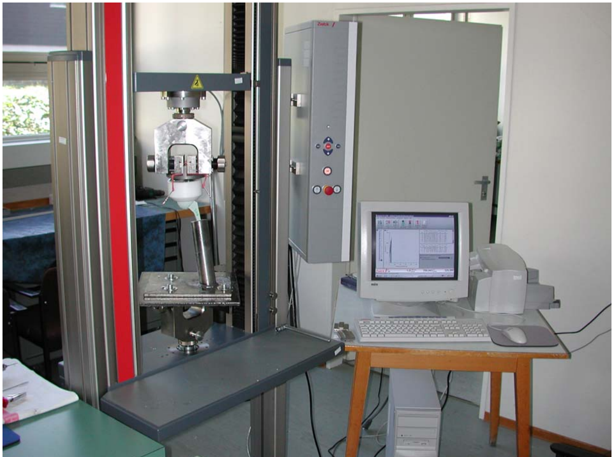
Abb.4: Zwick- Tischprüfmaschine vom Typ Z 020 (TC-FR 020TH.A50.) im biomechanischen Labor der Klinik für Orthopädie und Orthopädische Chirurgie des Universitätsklinikums des Saarlandes.
