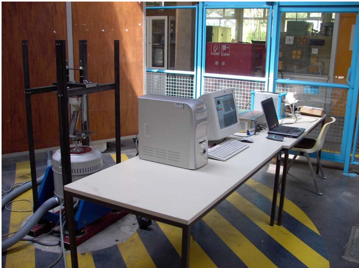
Abb.5: TIRA-Werkstoffprüfmaschine mit angeschlossenem EDV-System, Faculté des Sciences, de la Technologie et de la Communication, Université du Luxembourg
