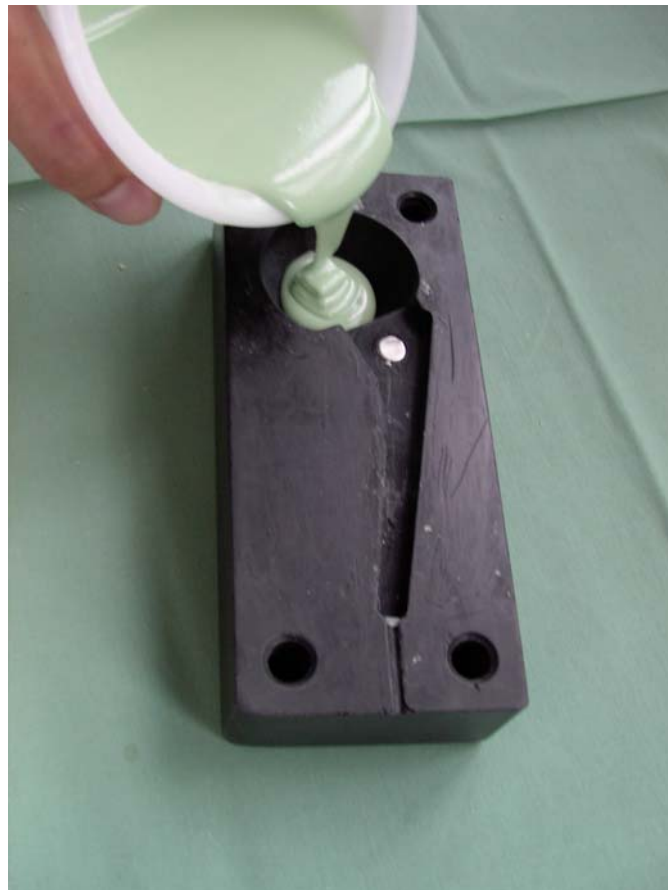
Abb.7: Eingießen des flüssigen PMMA's in die Gussform.
