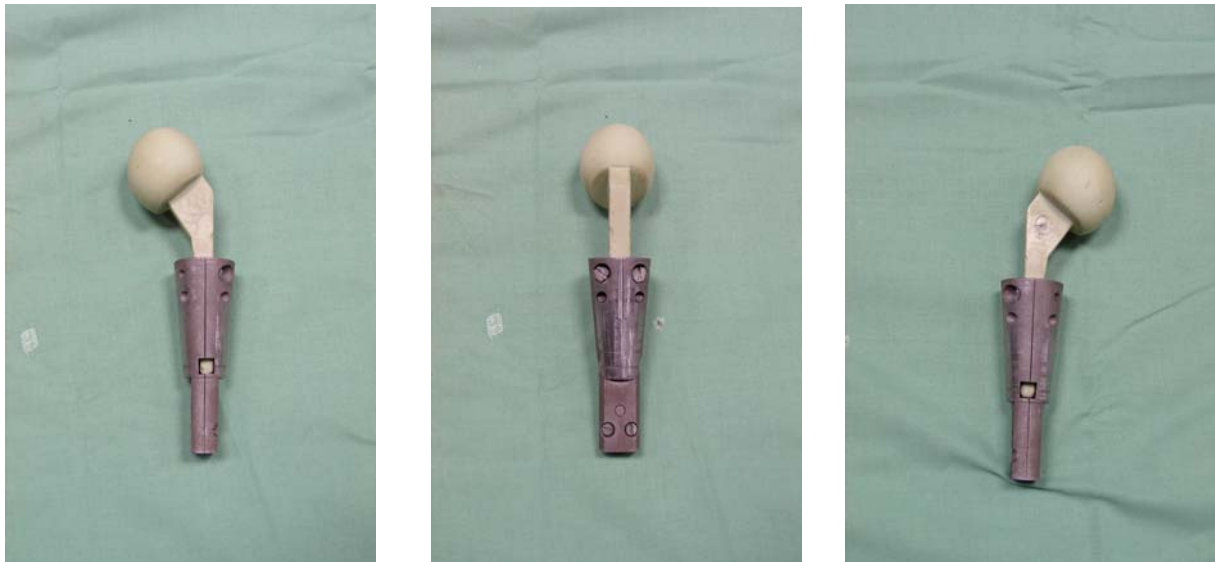
Abb.11: Die Abbildung zeigt einen in zwei Halbschalen fixierten PMMA-Spacer wie er bei der Testung verwendet wird.
