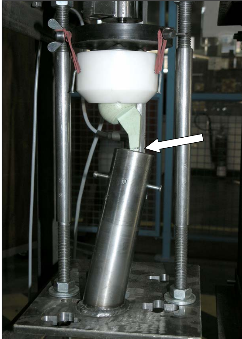
Abb.15: Bruch des Spacers zwischen fixiertem und unfixiertem Anteil (siehe Pfeil)
