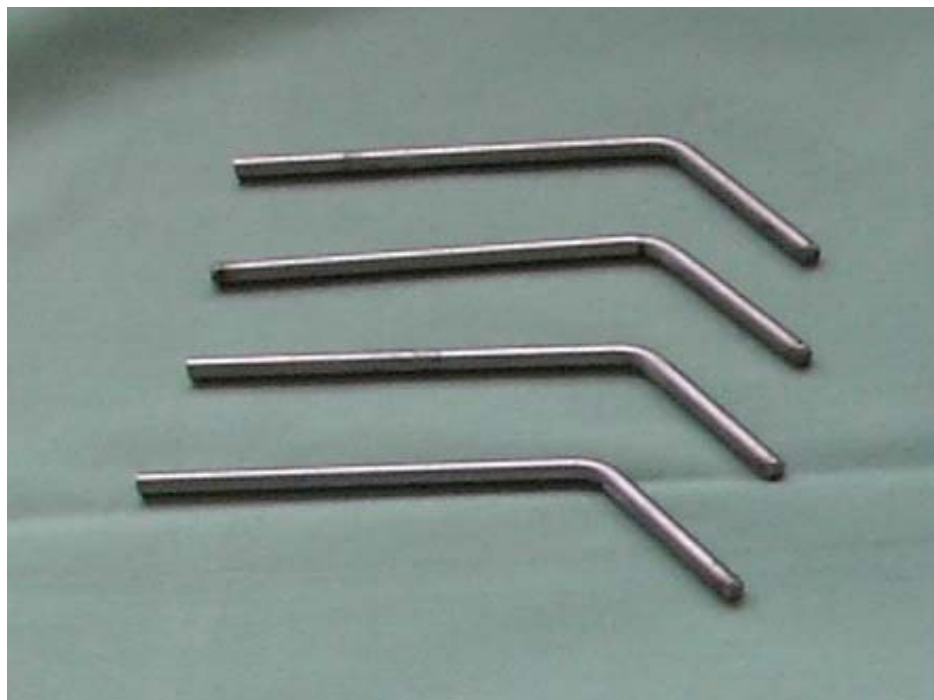
Abb.2: Bearbeitete TiAl 6V4-Metallendoskelette vor dem Einbau
