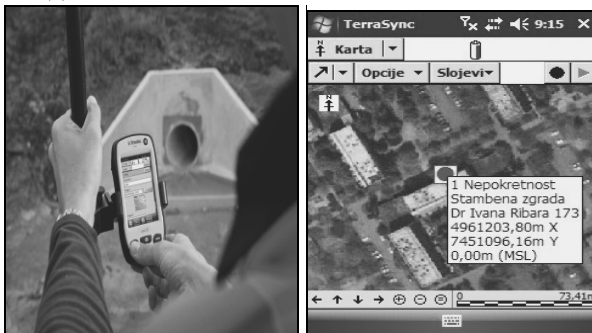
Слика 12 – ГПС уређаји за ГИС марке TRIMBLE – Juno 3 и софтвер за прмер и прикупљање атрибутивних података TerraSync 7
