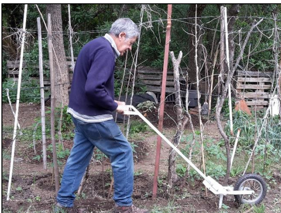
Figura 6. Herramienta desmalezadora de cultivos en hileras.
